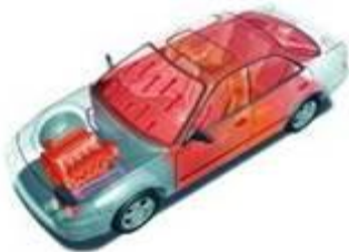
De standkachel verwarmt het motorblok en het interieur
